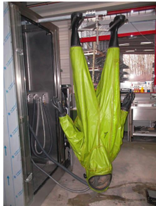
Abb. 4-CSA mit Kabinenanschlüssen komplett auf dem Tragegestell vor der BSP2-V am Stiefelhalter hängend
