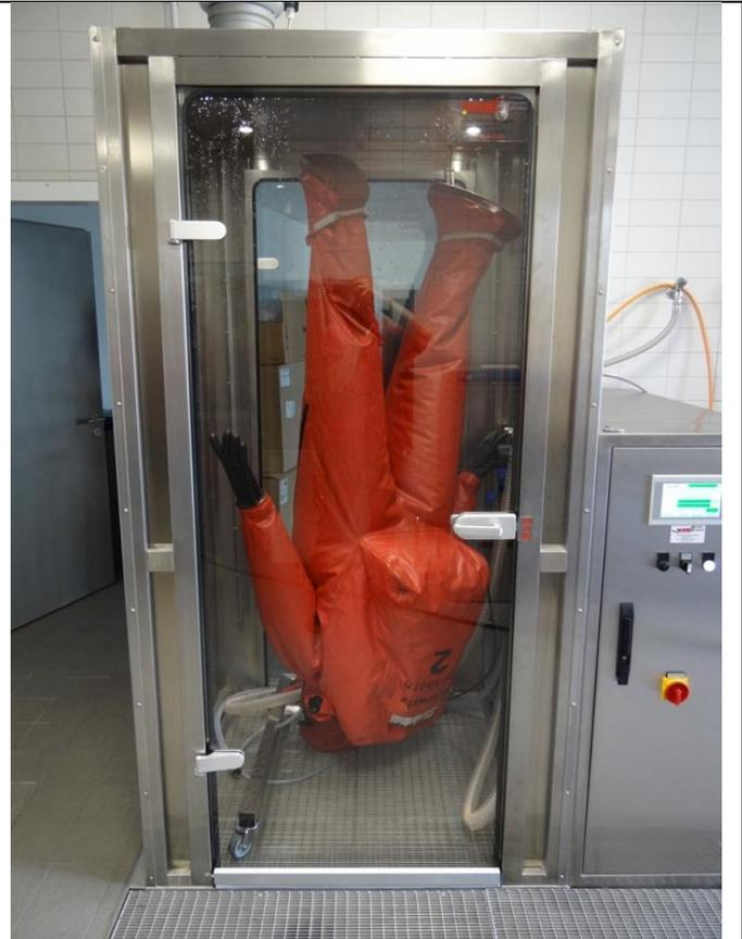
Abb. 17-Chemieschutzanzug auf dem Tragegestell (siehe „Inbetriebnahme und Programme“ -> „Bestückung CSA-Tragegestell“).
