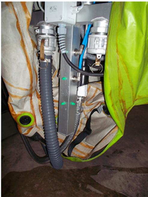
Abb. 3-Kabinenanschlüsse am CSA-Tragegestell
