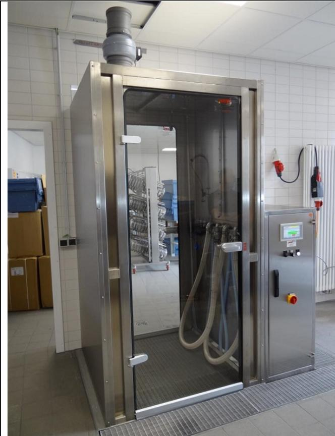
Abb. 16-Reinigungskabinenrost ist auf einer Ebene mit dem Fußboden.
