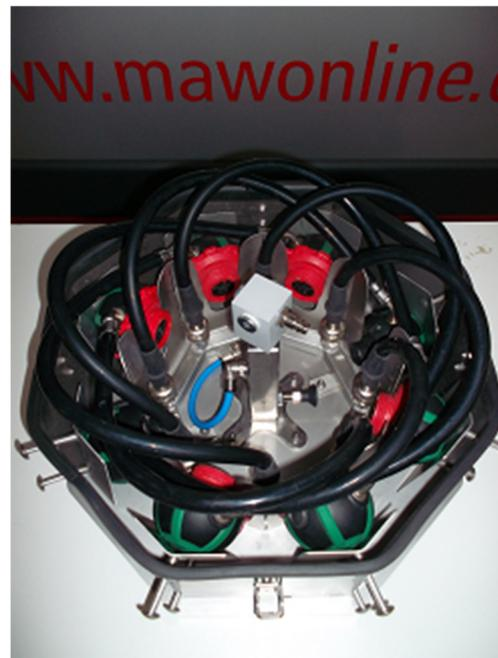
Abb. 8-Lungenautomaten angeschlossen in der Aufnahmetrommel
