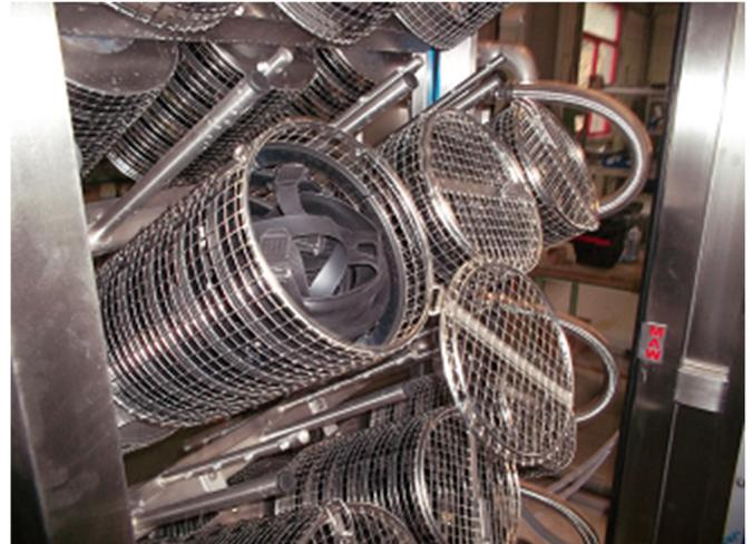
Abb. 6-Atemschutzmaske im Korb am Modul
