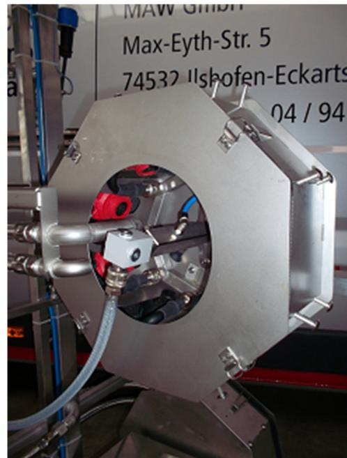
Abb. 10-Lungenautomaten in der Trommel am Modul
